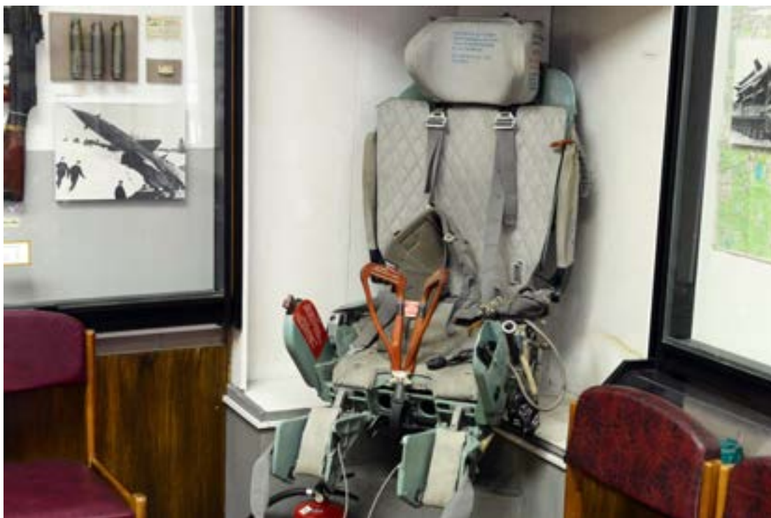
Катапультное кресло КМ-1М, устанавливавшееся на самолётах МиГ-21, МиГ-23, МиГ-25, МиГ-27
